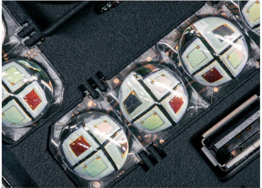
**Bild 3.** Das Beleuchtungsportfolio von B&R ermöglicht bis zu vier Lichtfarben pro Leuchte. Speziell entwickelte Linsen sorgen für eine homogene Ausleuchtung (© B&R)
